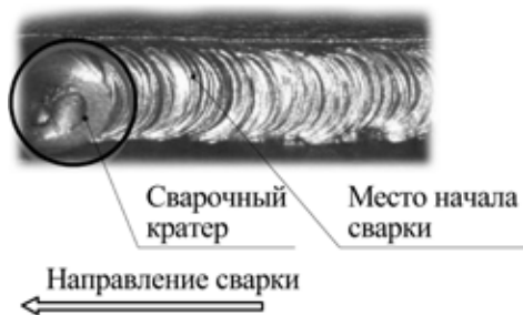
Рис. 8.4. Начало сварки при смене электрода.
